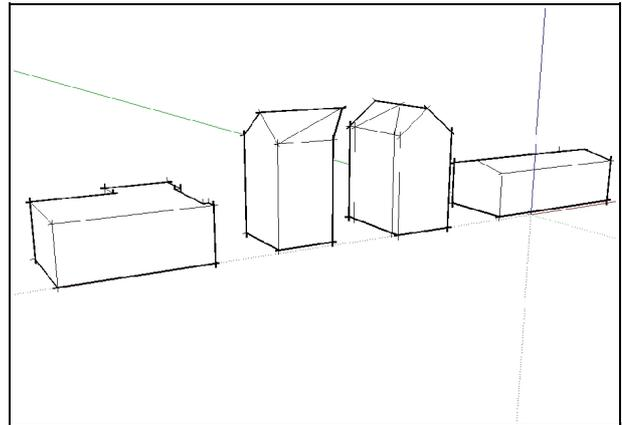
Das Modell besteht aus vier Gebäudeteilen: Hauptgebäude längs, Hauptgebäude quer, Anbau I, Anbau II mit Flachdach.
